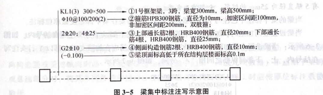
图 3-5 梁集中标注注写示意图
